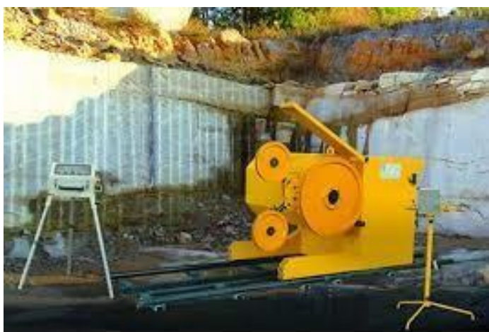
Máy cắt đá dây kim cương/ Stone cutting machine using diamond wire
